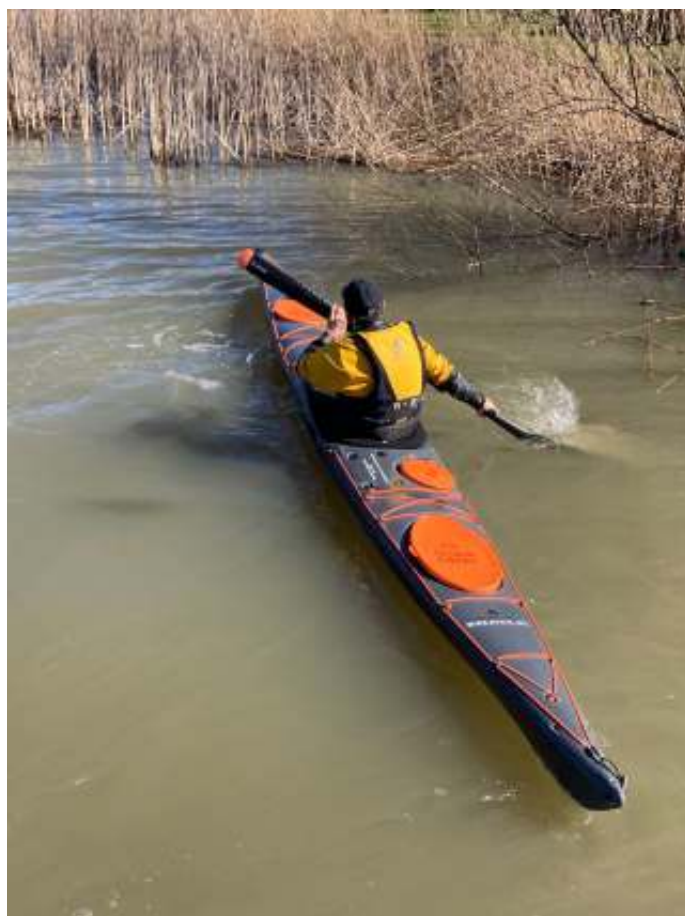
De Endless (voor gevorderden) is er in twee maten. Regular 520 lang, 50 breed, 24kg. Large 530 lang, 52 breed, 26 kg.
