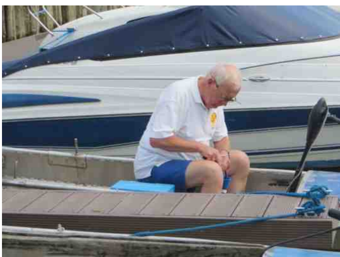
Fluisterboot, accu's en stekkers blijven de aandacht vragen van Flip. Na een uitbundige rit van een RV-lid om stekelig drijf hout uit de haven te halen bleek de stekker aan ellkaar gesmolten. Kan het een tandje lager, moet Flip hebben gedacht met uiteraard een diepe zucht. Een nieuwe stekker deed wonderen met het advies aan iedereen om niet voluit te varen om herhaling te voorkomen..
